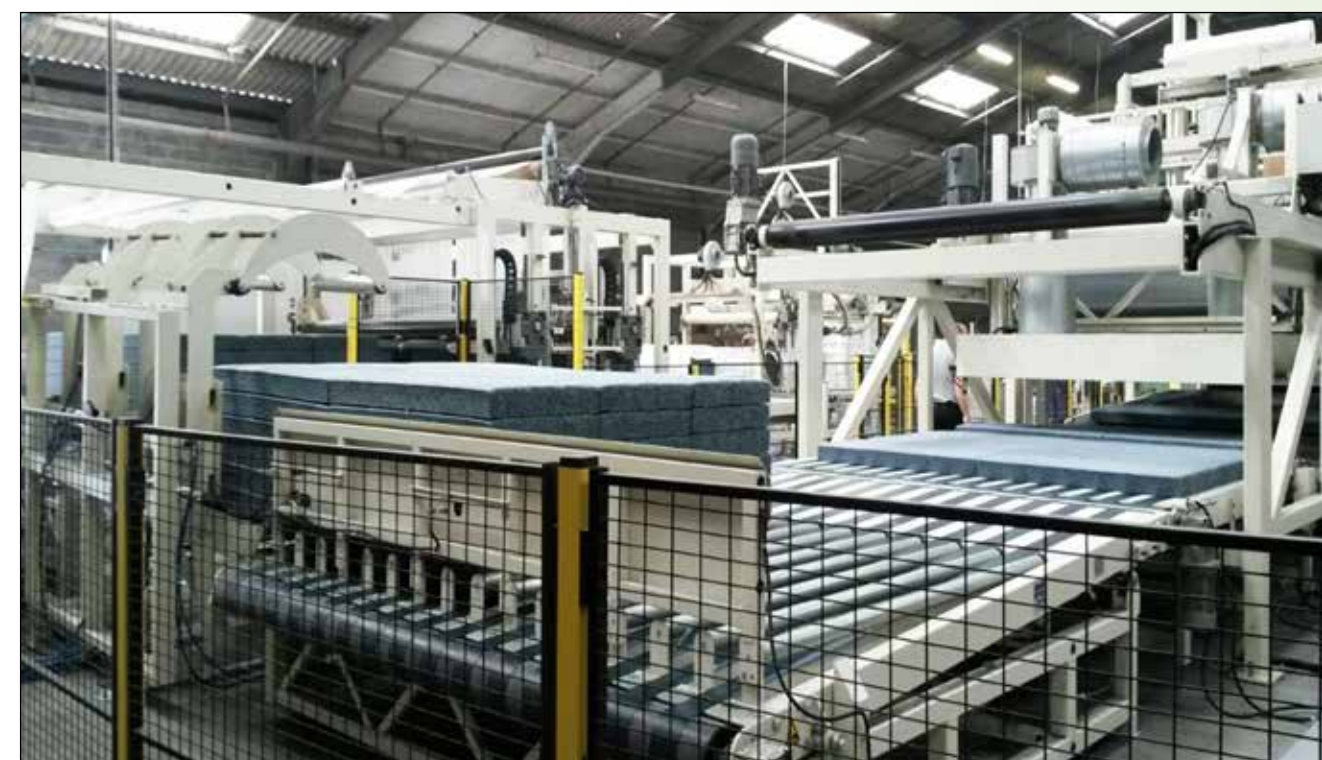
In een in eigen huis ontwikkelde machine worden de textielvezels gemengd met een bindende textielvezel en thermisch tot het isolatiemateriaal Métisse geperst
